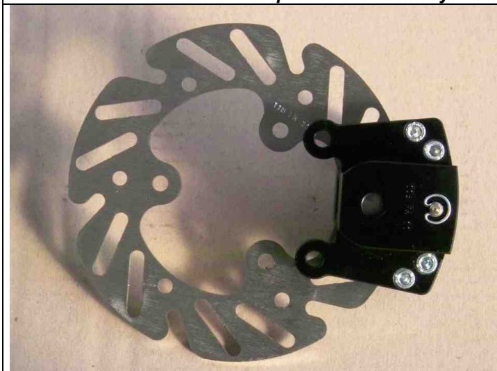
Photo du frein avant : étriers et disques seulement Photo of front brake: calipers and discs only
