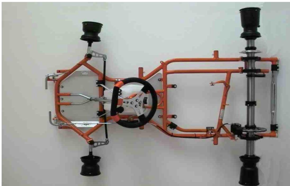
PHOTO VUE DE DESSUS DU CHÂSSIS COMPLET IDENTIQUE À L'UN DES MODÈLES PRÉSENTÉS À L'HOMOLOGATION SANS PARE-CHOCS, CARROSSERIE, SIEGE, NI PNEUMATIQUES
